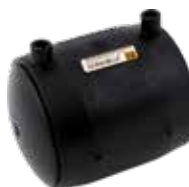
Serie 1201/01 Svejseslutmuffe PE100 Vand PN16/Gas 10 bar ø20-250
