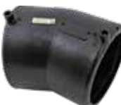
Serie 1203/21 Svejsøbøjning 22.5° PE100 Vand PN16/Gas 10 bar ø180
