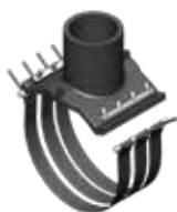
Serie 1209/10 og 1209/20 Tilslutningsbøjle, topload PE100 Vand PN16/Gas 10 bar 110-180mm udtag ø315x110-630x180
